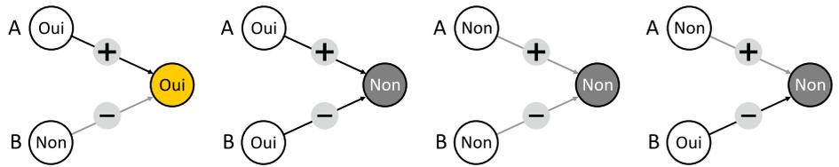
Anna et Ben construisent alors une plus grande machine (image ci-dessous) et sont sûrs qu'elle peut être un détecteur de conflit : l'état de Z ne doit être Oui que lorsque les états de A et B sont différents (Oui et Non ou Non et Oui). Sinon, Z doit être dans l'état Non. Il ne reste plus qu'à régler les câbles correctement.
